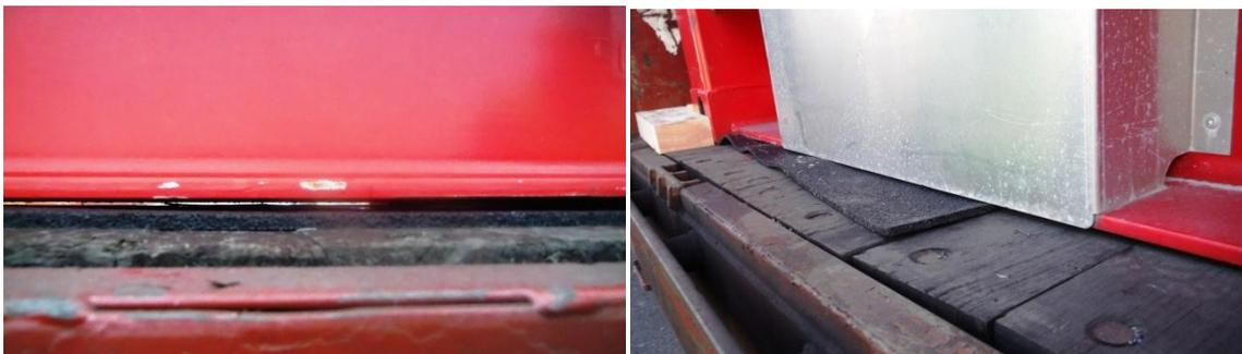
La surface totale en contact des blocs ISO avec l'Antigliss est de 0.084 m<sup>2</sup>.
