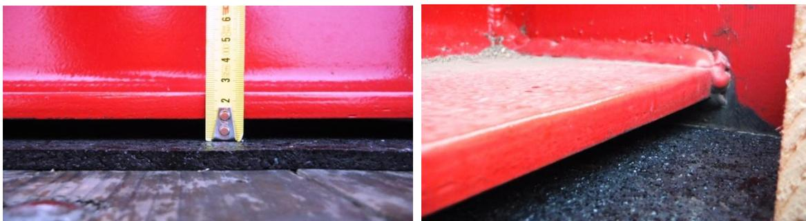
Un essai à 2 épaisseurs ne s'est pas avéré plus efficace, la bande antiglisse mesurant 8 mm d'épaisseur soit 16mm avec un écart de 18 mm entre bloc iso et châssis conteneur,
