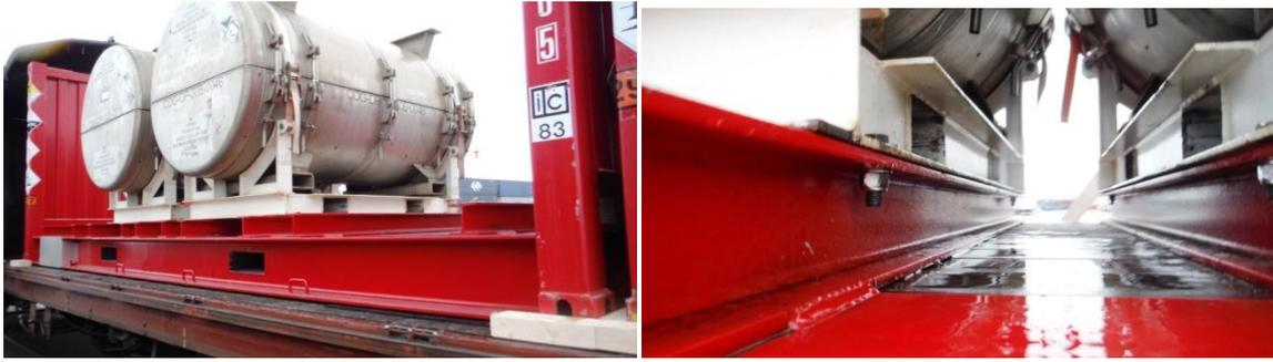
Les bers de cylindres sont boulonnés aux traverses soudées par 4 boulons M18 NILSTOP je n'ai pas vu de plot de centrage.
